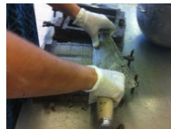
Figura 3.26 Alisamento da superfície dos moldes
