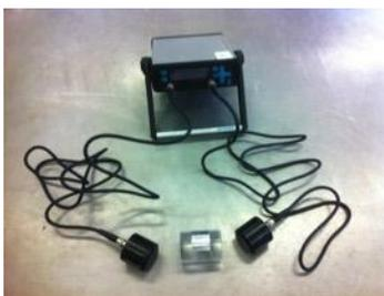
Figura 3.36 Equipamento *PUNDIT LAB*
