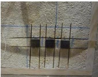
Figura 3.57 Pastilhas coladas na argamassa aplicada em parede
