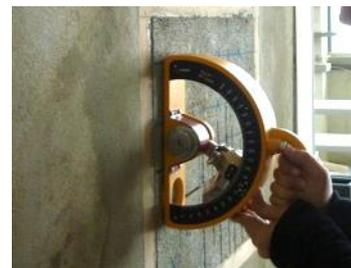
Figura 3.62 Ensaio de esclerómetro na parede
