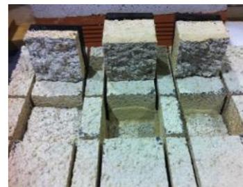
**Figura 4.20 Resultado final do ensaio de arrancamento da argamassa H<sup>GCT</sup> aplicada em tijolo**
