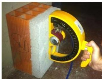
Figura 3.61 Ensaio de esclerómetro no tijolo
