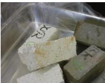
**Figura 3.76** Provetes a ensaiar à compressão provenientes dos provetes normalizados
