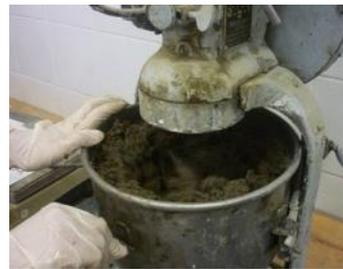
Figura 3.7 Mistura da massa com misturadora mecânica
