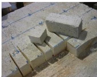
**Figura 3.77** Provelte a ensaiar à compressão proveniente de amostras da argamassa aplicada em parede
