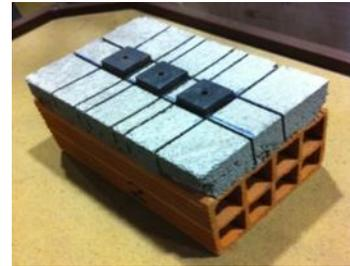
Figura 3.56 Pastilhas coladas na argamassa aplicada em tijolo
