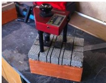
Figura 3.58 Aplicação da força através do aparelho de arrancamento a argamassa aplicada em tijolo
