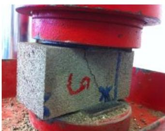
Figura 3.79 Ensaio à compressão de amostra de parede
