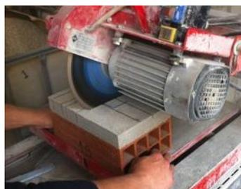
Figura 3.52 Realização dos cortes no tijolo para ensaio Pull-Off
