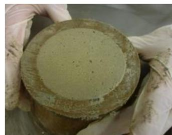
**Figura 3.32** Resultado do alisamento da argamassa no ensaio de espalhamento
