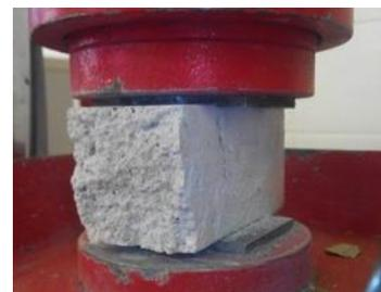
**Figura 3.78** Ensaio à compressão de meio provete prismático
