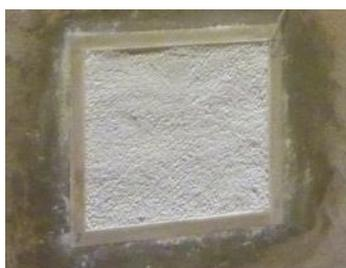
**Figura 4.7** Resultado final da aplicação da argamassa  $G^{EPS}$
