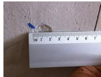
Figura 3.67 Medição do diâmetro da mocha produzida pelo equipamento de *Martinet Baronnie*
