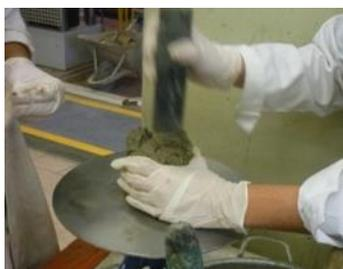
**Figura 3.31** Compactação da argamassa no ensaio de espalhamento
