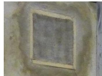
Figura 4.3 Resultado final da aplicação da argamassa  $C^{AE}$
