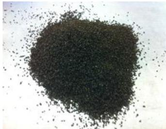
**Figura 2.2 Granulado de cortiça expandida**
