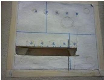
Figura 4.15 Destacamento da argamassa  $D^{Aero/AE}$  após cortes.
