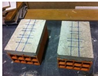
Figura 3.50 Marcações para o ensaio de Pull-Off num tijolo
