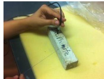
Figura 3.70 Leitura de frequência de ressonância do modo de vibração à torção
