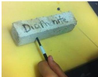
Figura 3.69 Leitura de frequência de ressonância do modo de vibração à flexão
