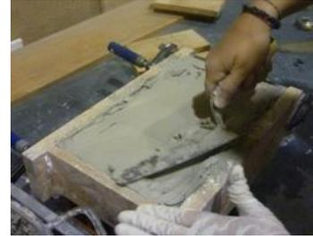
Figura 3.23 Aperto da argamassa com remoção do excesso
