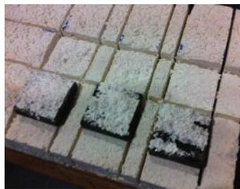
**Figura 4.19 Resultado final do ensaio de arrancamento da argamassa G<sup>EPS</sup> aplicada em tijolo**
