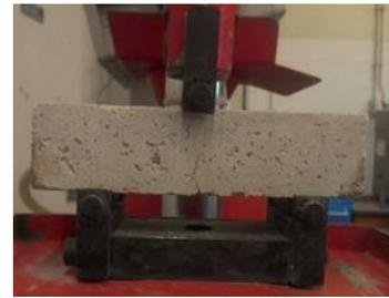
**Figura 3.75** Rotura do provete à flexão
