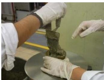
**Figura 3.30** Colocação da argamassa no molde no ensaio de espalhamento
