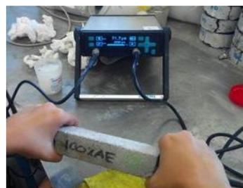
Figura 3.41 Medição do provete prismático
