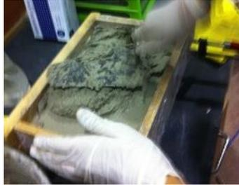
Figura 3.22 Aplicação da argamassa no tijolo
