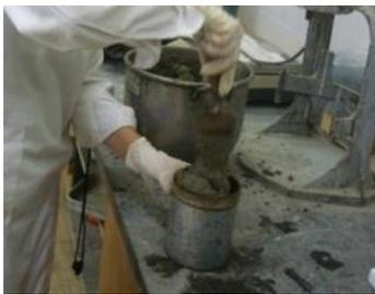
Figura 3.27 Colocação da argamassa no copo metálico
