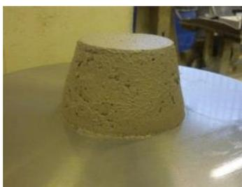
**Figura 3.33** Após remoção do molde no ensaio de espalhamento
