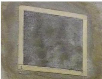
Figura 4.1 Resultado final da aplicação da argamassa  $A^{con}$
