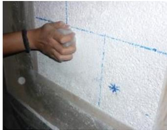
Figura 3.55 Alisamento do local de colagem das pastilhas metálicas
