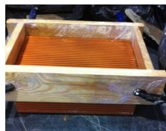
Figura 3.3 Suporte tijolo com cofragem
