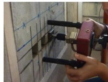
Figura 3.59 Aplicação da força através do aparelho de arrancamento a argamassa aplicada em Parede
