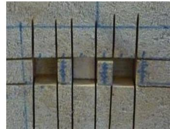
Figura 4.17 Ensaio *Pull-Off* na argamassa  $H^{GC/T}$  nos protótipos de parede
