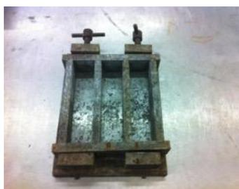
Figura 3.2 Molde metálicos dos provetes prismáticos
