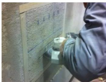
Figura 3.51 Realização dos cortes na parede para ensaio Pull-Off
