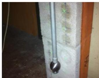
Figura 3.66 Ensaio de *Martinet Baronnie* no tijolo
