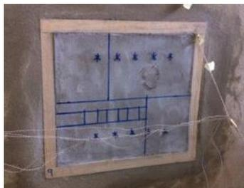
Figura 3.49 Marcações para o ensaio de Pull-Off num protótipo de parede
