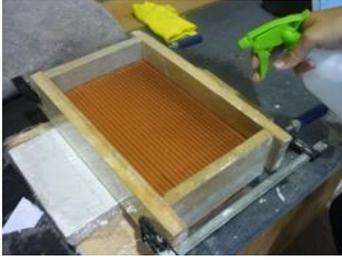
Figura 3.21 Humidificação do suporte de tijolo
