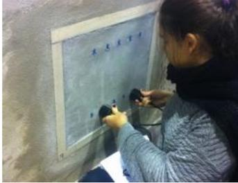
Figura 3.45 Exemplo de medição do método indirecto na parede
