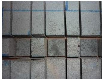
Figura 4.16 Ensaio *Pull-Off* na argamassa  $B^{GC}$  nos protótipos de parede
