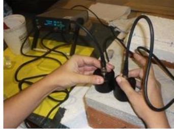
Figura 3.46 Exemplo de medição do método indirecto no tijolo
