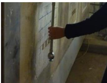
Figura 3.65 Ensaio de *Martinet Baronnie* na parede
