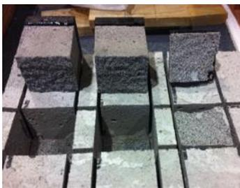
**Figura 4.18 Resultado final do ensaio de arrancamento da argamassa B<sup>GC</sup> aplicada em tijolo**
