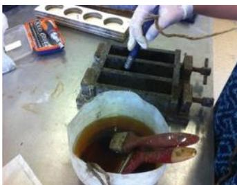
Figura 3.24 Colocação de óleo mineral descofrante nos moldes
