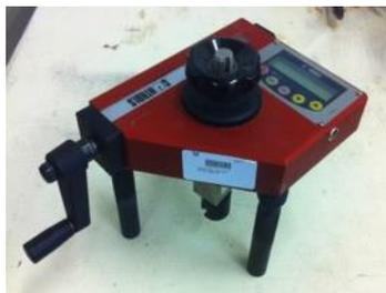
Figura 3.48 Equipamento de ensaio de Pull-Off
