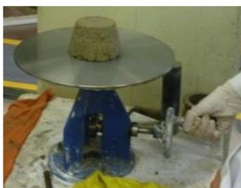
**Figura 3.34** Equipamento do ensaio de espalhamento
